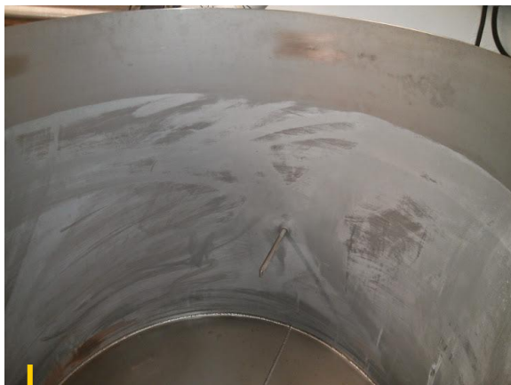
Traces de bierstein sur la paroi d'une cuve
